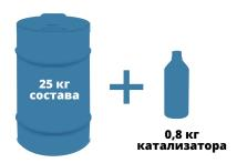
Подготовить состав и заранее определенное количество катализатора (согласно табл. Реакционная способность). Емкость с катализатором перед использованием хорошо встряхнуть.
